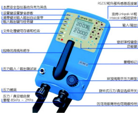
DPI610/615 为一体化电池供电仪表，自带压力源，具有压力控制微调、电源输出和测量等功能，同时还可提供4~20mA回路测试和数据储存。仪表结构坚固紧凑。屏幕宽，双参数显示，使用户在操作DPI610/615手泵和连接测试线时，仍能清晰地读出参数。面板键盘具有弹性好、手感好和寿命长等优点。毫安阶跃和斜率输出以及内部的持续测试功能方便了对回路控制的维修和保养。
