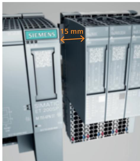
普通分布式系统需要额外的电源模块建立负载组，SIMATIC ET 200SP 集成电源模块，该特性可以有效节约柜内空间，提高可用性。
