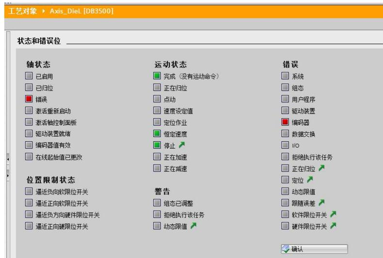
图 1-1 定位功能中检测到编码器故障
