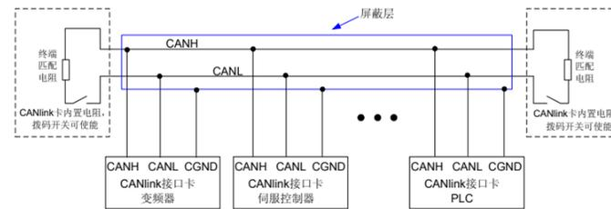
图2.4 CANlink总线连接拓扑图
