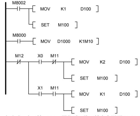
启动时,先正转,M100置位后,将正转命令写到U3-17,然后M100会自动复位。当检测正转位置到达X0后,反转命令写到D100并置位M100写到变频器U3-17。反转到达X1再执行正转,如此循环。程序中,D1000存放变频器返回的状态(U0-68,H7044),并将其低四位对应M10-M13。U0-68各Bit定义如下表:
